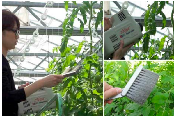
図4 zNoseによる匂い成分計測の様子(ブラッシング処理と on-siteでの空気サンプリング)
